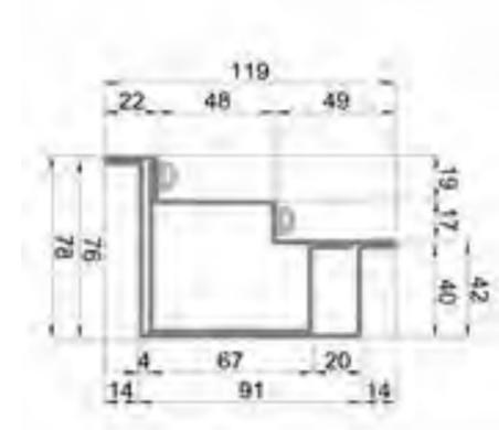
TELAIO LATO SERRATURA
