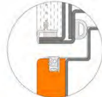
Controtelaio raso muro interno e esterno con retina speciale per tenuta intonaco
